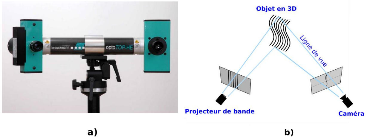
Figure 2.13.1 ) Scanner 3D OptoTOP-HE de Breuckmann. b) Schéma qui montre le principe de fonctionnement du scanner Breuckmann.
