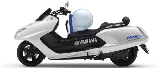
FIGURE 1.11 – Illustration du prototype d’airbag sur le prototype ASV-3 de Yamaha
