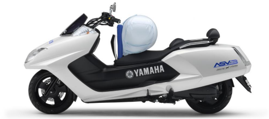
FIGURE 1.11 – Illustration du prototype d’airbag sur le prototype ASV-3 de Yamaha
