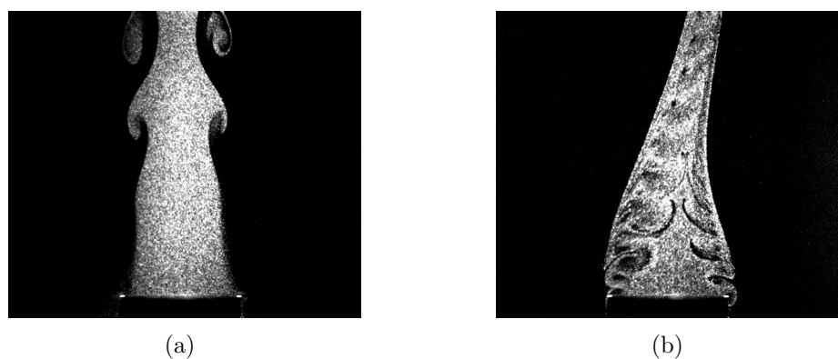
FIGURE 7.24 – Vues tomographiques verticales pour U_{bulk} = 2.1\text{m/s} , f_0 = 1010\text{ Hz} et \tilde{P}_{b.e.} = 62\text{ Pa} : (a) jet d’air ; (b) jet d’hélium.
