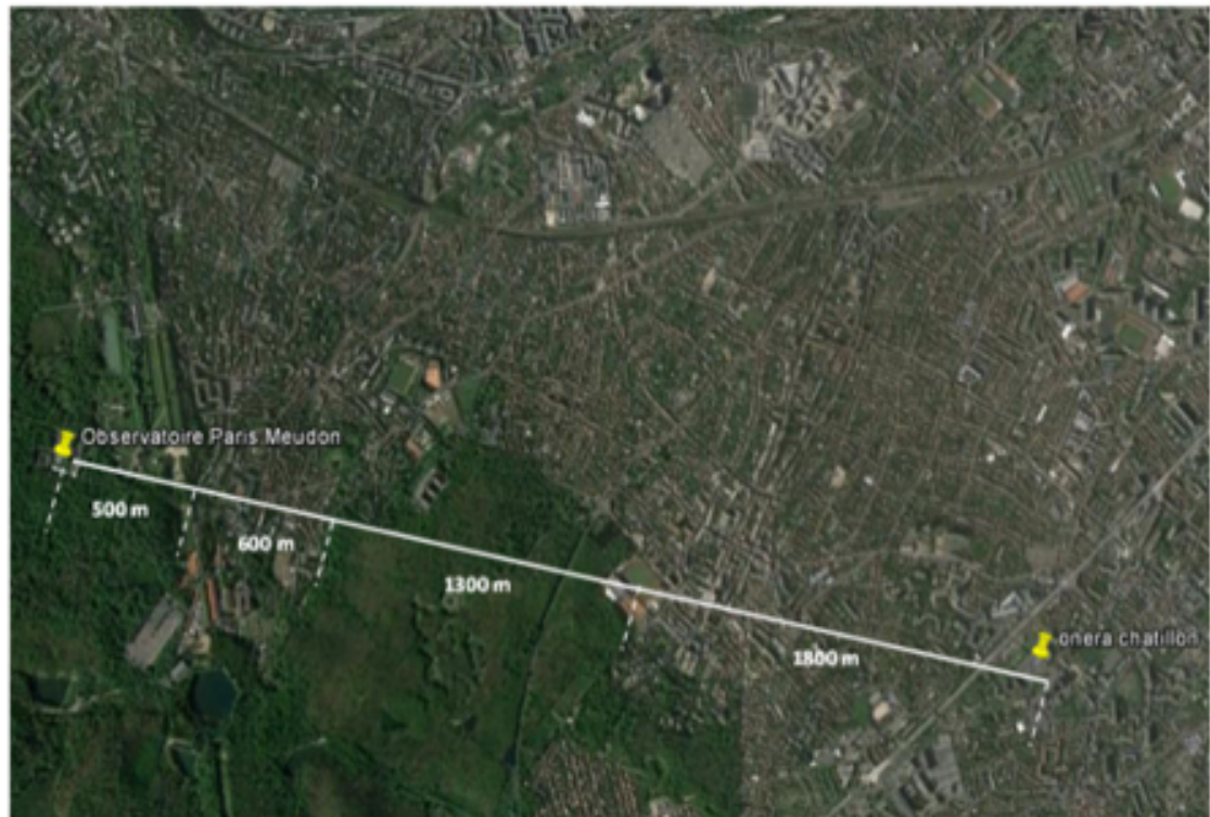
FIGURE 4.1: Ligne de visée horizontale pour l'expérience Châtillon-Meudon.
