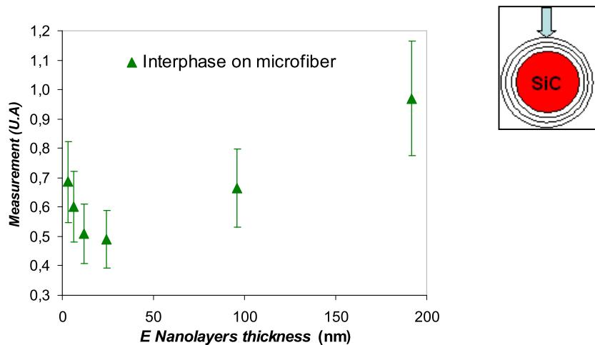
**Figure II.9 :** Mesure SThM en fonction de l'épaisseur des films qui composent l'interphase (Rapport DRT de Lagrange 2006 ; C.3, 2009).
