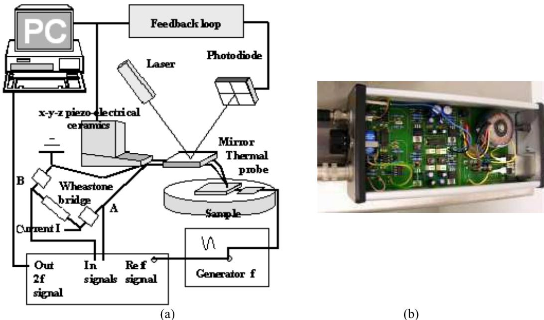
**Figure II.4 :** (a) Schéma typique d'un pont de Wheatstone utilisé pour l'analyse de champ de température en surface d'un échantillon actif en régime ac (A11, 2007). Photographie d'un amplificateur d'isolation réalisé en collaboration avec le Laboratoire Ampère (Villeurbanne).
