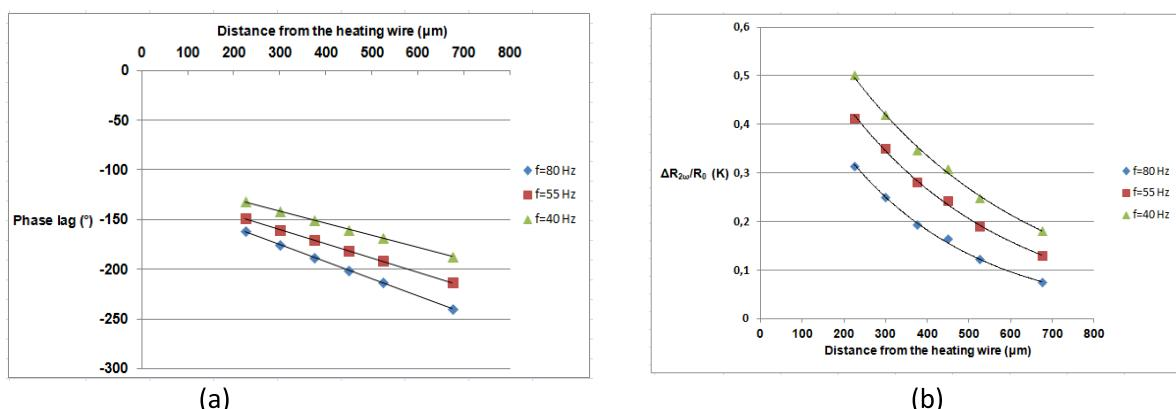
**Figure AVII.2:** Variations du déphasage (a) et de l'amplitude (b) de la tension à la fréquence  $2f$ , mesurée en face avant de l'échantillon, en fonction de la distance à la source pour différentes fréquences et un courant modulé dans la source de  $60\text{mA}$ . La diffusivité thermique du silicium est estimée à  $5,3 \pm 0,3 \cdot 10^{-5} \text{ m}^2/\text{s}$  à  $485 \text{ K}$ , ce qui est en très bon accord avec la littérature scientifique<sup>3</sup>.
