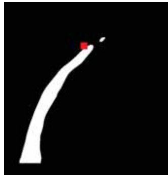
FIGURE 7.2. – Méthodologie pour mesurer la fréquence de battement du jet, une FFT est faite sur le signal de fraction volumique binarisé au point indiqué par le carré rouge.
