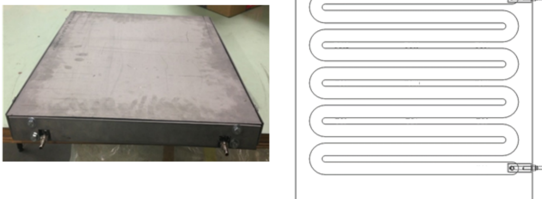
Figure 4.2 – Outillage innovant MATTE (à gauche) - Canaux de chauffe (à droite)
