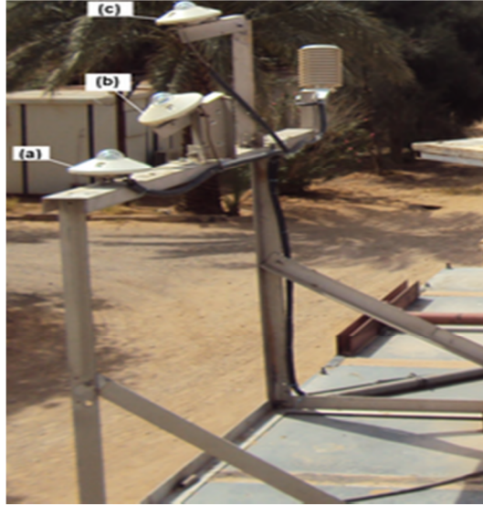
Fig.I.21 : Photo de la station radiométrique de l'URER'MS d'Adrar : (a) mesure le rayonnement global horizontal, (b) mesure le rayonnement incliné suivant la latitude, (c) mesure le rayonnement avec une inclinaison variable.
