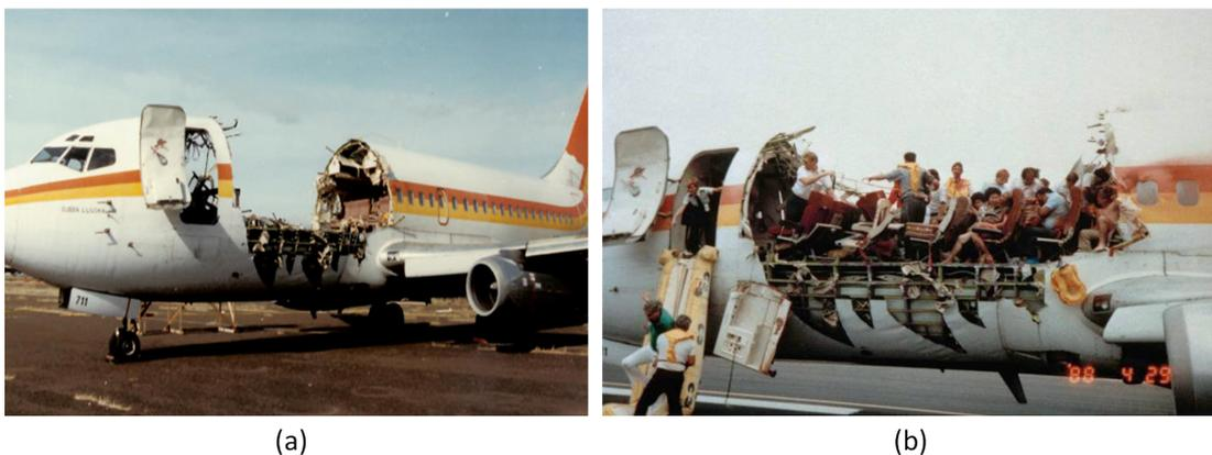
FIGURE 2: Conséquences des accidents graves : a) Aloha Airlines Flight 243 (vue de loin) b) Aloha Airlines Flight 243 (vue de proche)
