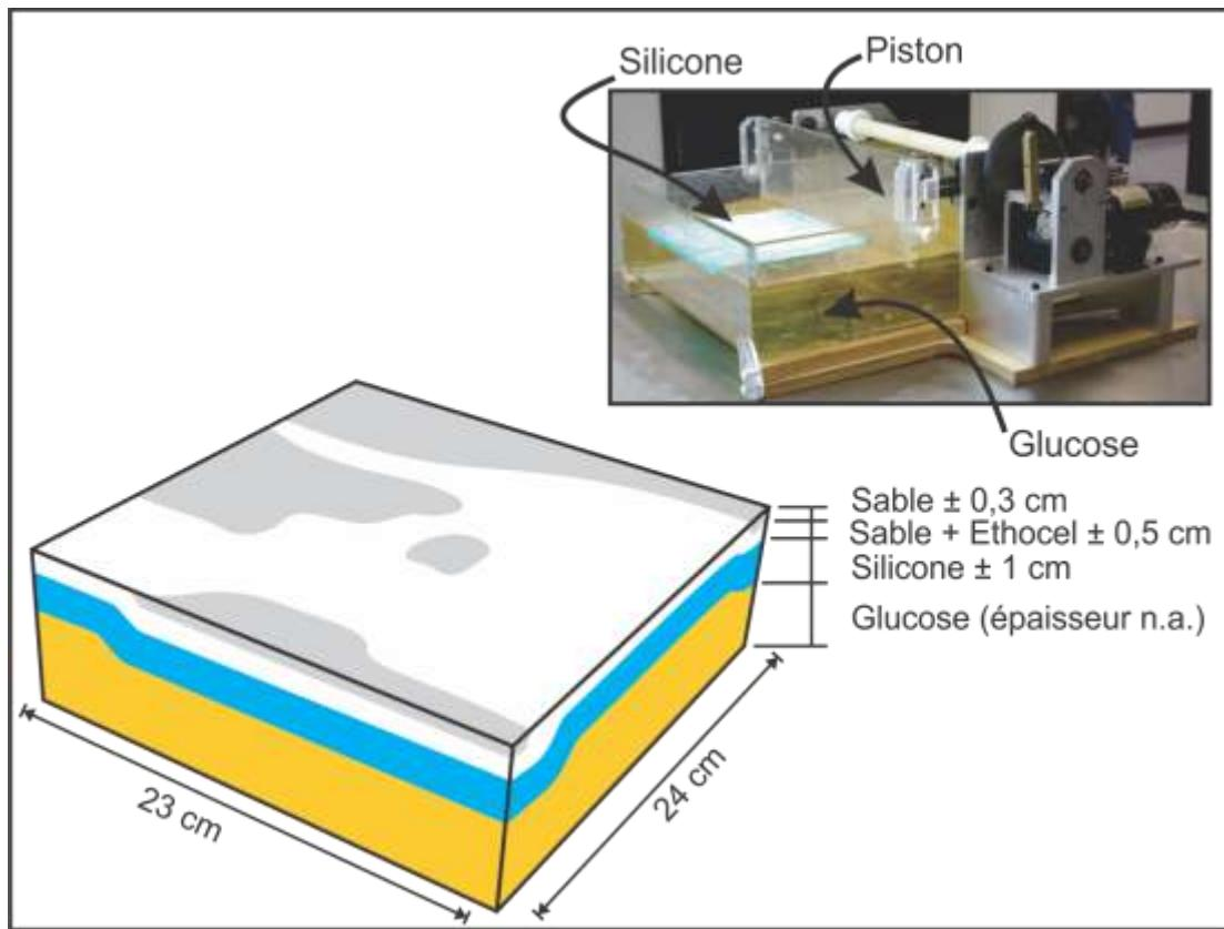
Figure 1.7 : Dispositif expérimental
