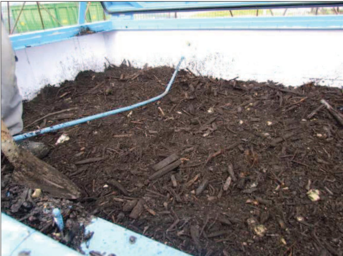
**Figura 7.8** – Un'immagine del materiale filtrante all'interno del bio-container
