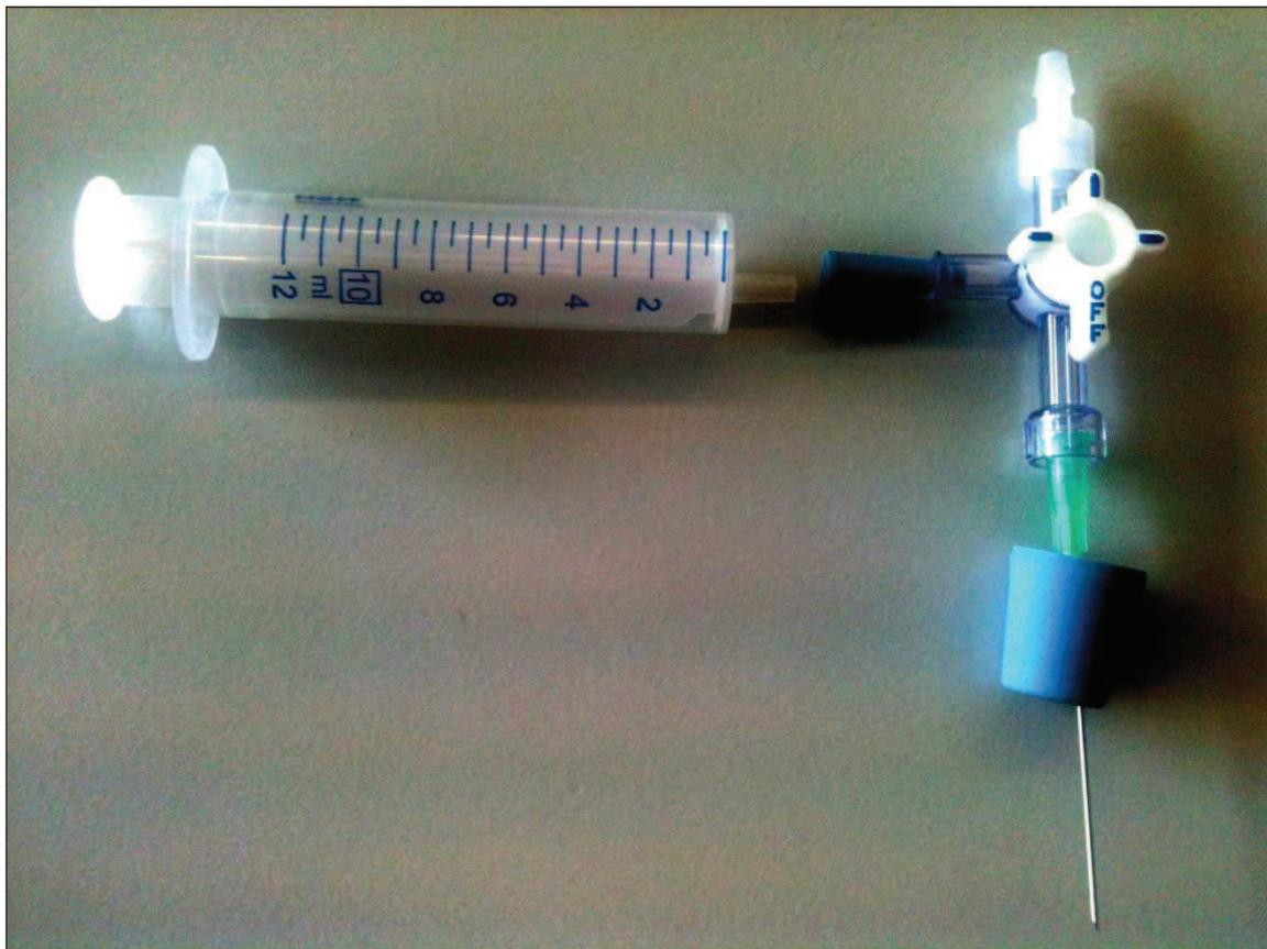
**Figura 6.16** – Sistema di valvole utilizzato per il campionamento del gas in uscita dalla colonna di bio-ossidazione
