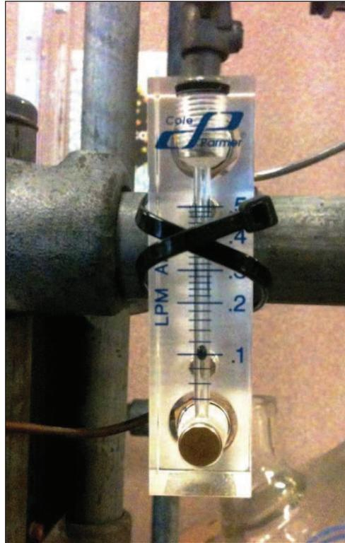
**Figura 6.9** – Flussimetro impostato a 0.1 l/min.
