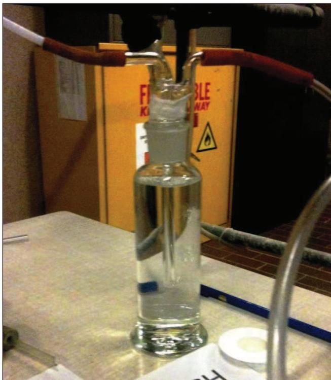
**Figura 6.13** – Sistema per la saturazione del gas in input alla colonna
