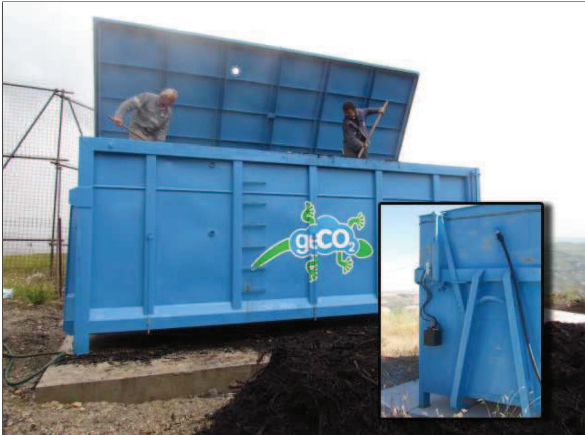
**Figura 7.4** – Un'immagine del riempimento del container aperto con il sistema idraulico
