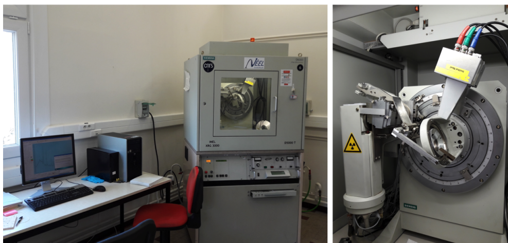
FIGURE 0.0.24 – Diffractomètre en transmission Siemens D5000T ( \lambda_{Cu,K\alpha1} = 1.54059\text{\AA} ), géométrie "Bragg-Brentano" en \theta/2\theta
