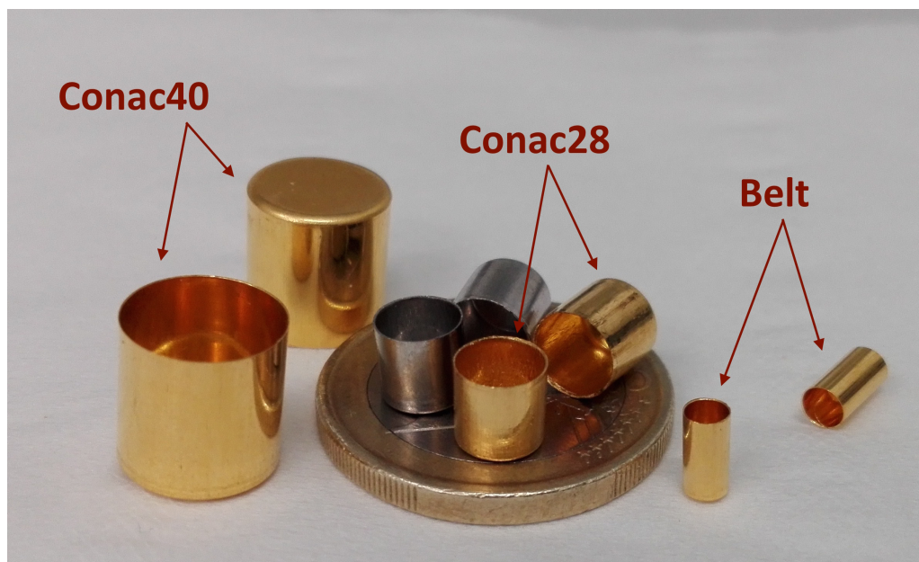
FIGURE 0.0.12 – Capsules utilisées lors des synthèses en presse gros volume Belt et Conac28/40 en or ainsi qu’une deuxième paire de capsule Belt en platine.
