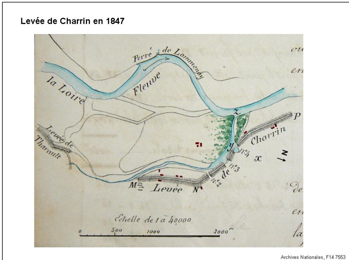
Figure 87: Impact de la crue du 18 et 19 octobre 1846 sur la levée de Charrin (Commune de Charrin). Levée défensive.
