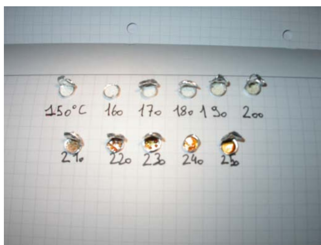
Figure 102 : Photo des creusets DSC, différentes température de fin d'analyse
