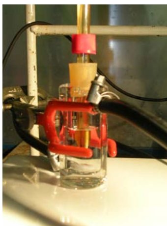
Figure 37 : Cellule double enveloppée de 10 mL pour la mesure de solubilité
