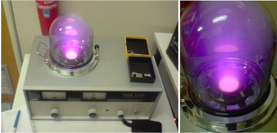
Figure 62 et 63 : Métalliseur Jeol et sa cloche d'évaporation
