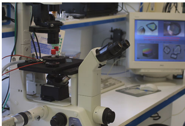
Figure 39 : Microscope optique inversé équipé d'une platine à effet Peltier
