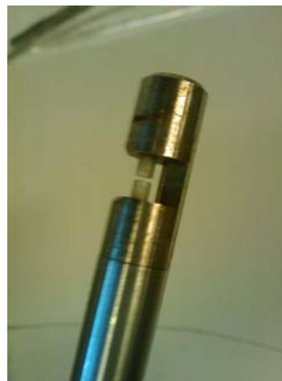
Figure 81 : Sonde vidéo in situ de 12mm de diamètre
