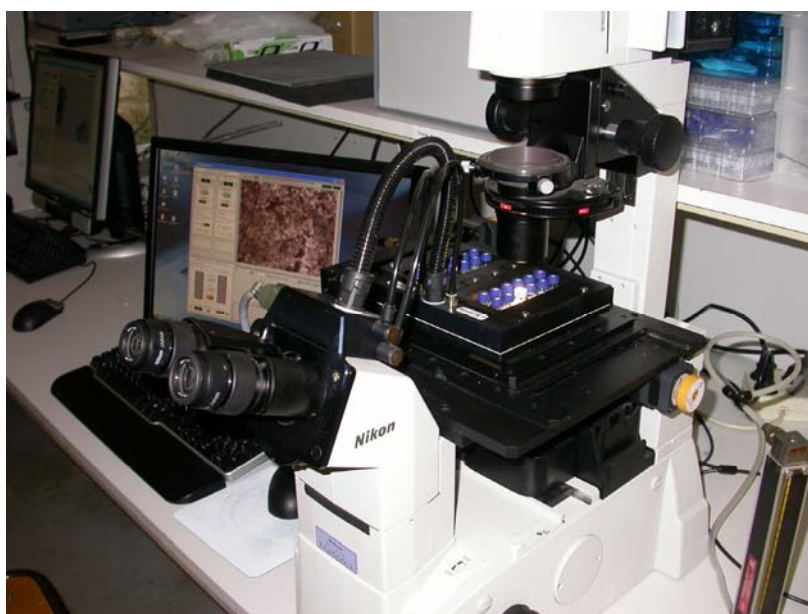
Figure 105 : Photo du montage multipuits pour 24 vials
