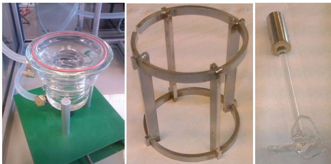
Figures 72, 73 et 74 : Photos de la cuve, des contrepaies et de l'agitateur en verre
