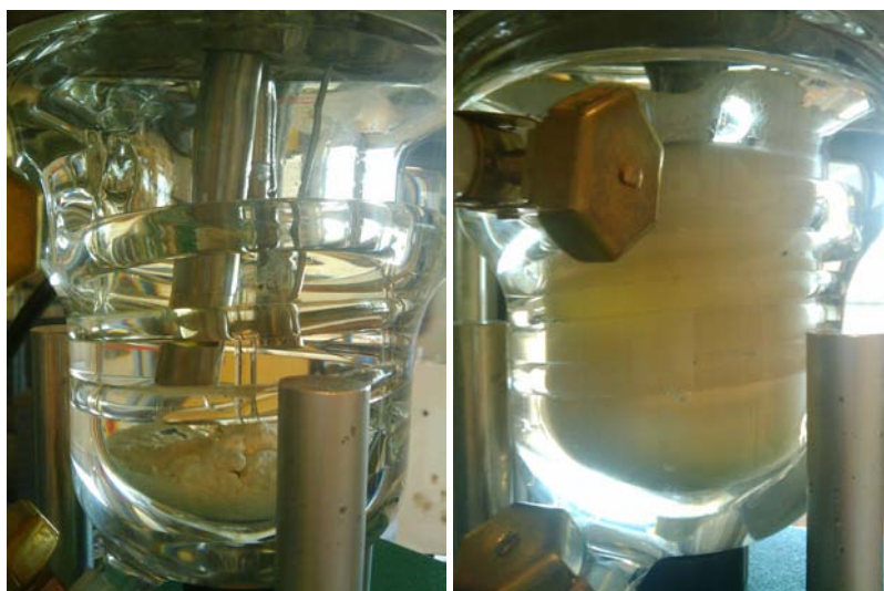
Figures 75 et 76 : Photos des 3 sondes dans le réacteur, avant et pendant l'agitation
