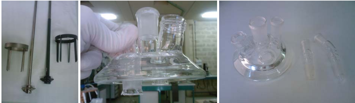
Figures 66, 67 et 68 : Photos de l'agitateur métallique et des contrepales avant et après recouvrement par un polymère protecteur, du ciel du réacteur et des accessoires en verres
