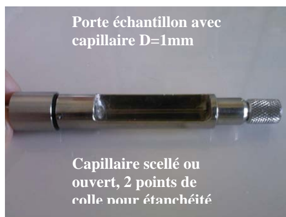
Figure 86 : Cellule capillaire pour étude SWAXS
