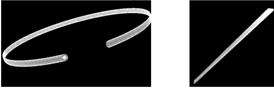
Figure 15. Utilisation de la synthèse par modélisation physique ( Modalys ) pour produire de la matière sonore. Le mécanisme de gong frappé est modélisé fidèlement dans un premier temps afin d'obtenir des sonorités réalistes (gauche) ; le modèle est ensuite extrapolé en termes de géométrie ou de matériau afin d'explorer de nouveaux espaces de timbre (droite).
