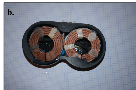
Figure 1.3 : a. Sonde plane avec deux bobines (modèle B-65 Magventure®) b. Intérieur de la même sonde avec l'enroulement des bobines de cuivre et le système de refroidissement.
