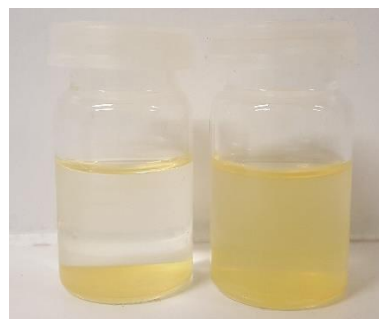
Figure 2.2 : (a) Suspensions de nanoparticules de \text{BiFeO}_3 à des concentrations décroissantes de gauche à droite. (b) Exemple de suspensions de nanoparticules instables et stables.
