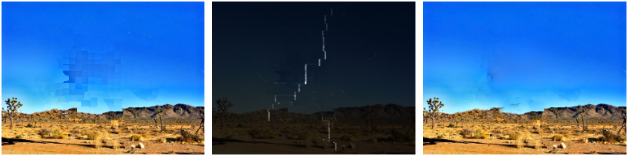
(a) Résultat d'inpainting basé motifs. (b) Carte estimée des amplitudes locales d'artéfacts visuels. (c) Résultat d'inpainting basé motifs + application de notre algorithme de mélange spatial de patches.
