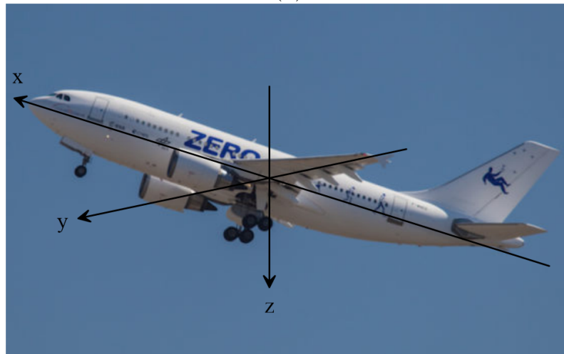
FIGURE 3.2 – (a) Enregistrements des accéléromètres embarqués à bord de l'avion ZERO-G ; (b) Photographie de l'Airbus A310 ZERO-G et report des axes x , y , z . Crédits Novespace.
