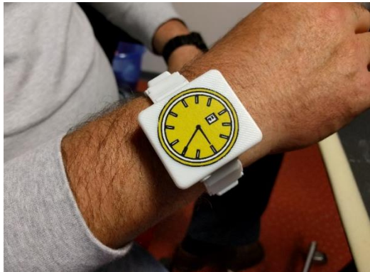
Figure 39 : bracelet vibrotactile porté par un participant.
