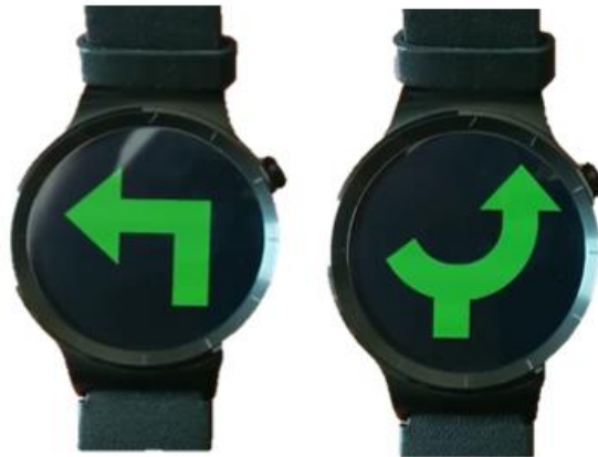
Figure 61 : montre connectée affichant des flèches de guidage annoncées par une forte vibration.
