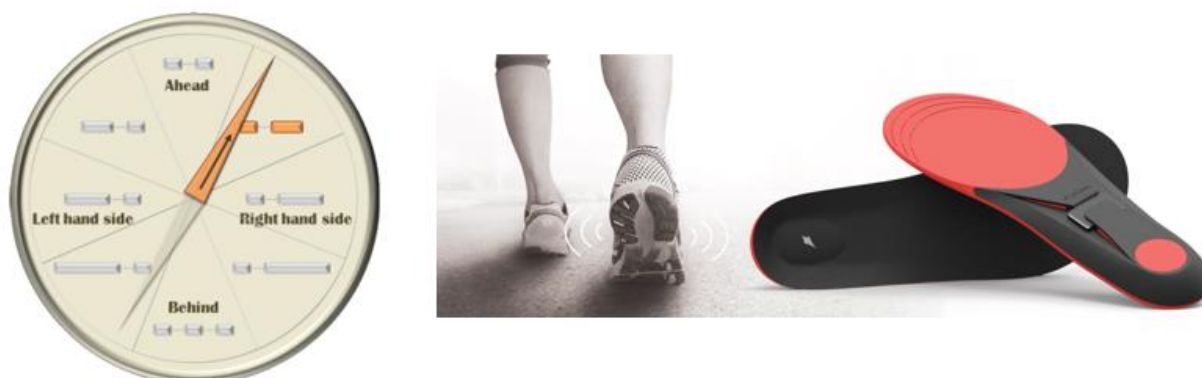
Figure 11 : Gauche : tactons développés par Pielot et al. (2012) dans le cadre de leur application PocketNavigator. Droite, chaussures et semelles haptiques
