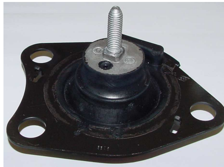
FIG. V.16 – Voûte de suspension moteur.
