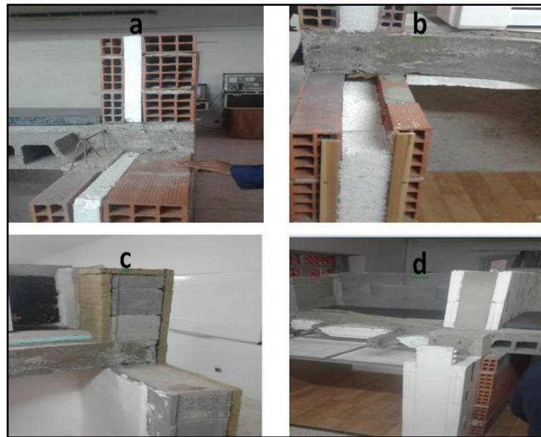
Figure 2. Quelques prototypes de murs avec isolation thermique, a : Mousse rigide de polyuréthane, b : Granulat de verre, c : Fibragglos (de bois), d : polystyrène expansé. (photos prises à la plate forme de l'AMEE, Marrakech 2017)
