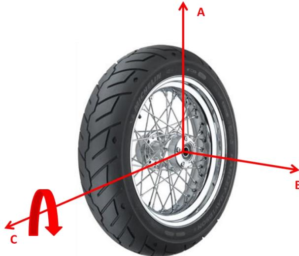
Figure 11 Effet gyroscopique de la roue
