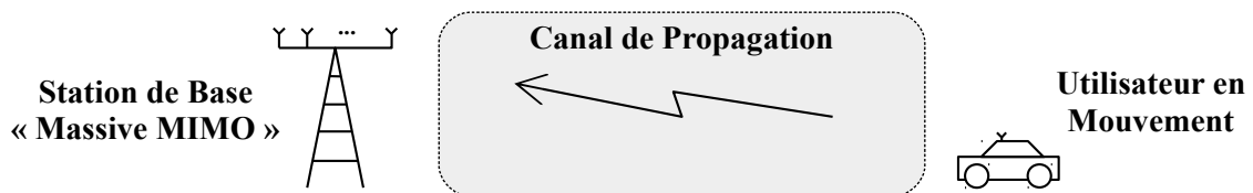
FIGURE 2 : Voie montante d'une communication entre un utilisateur en mouvement équipé d'une seule antenne et une station de base "massive MIMO" équipée d'un grand nombre d'antennes.
