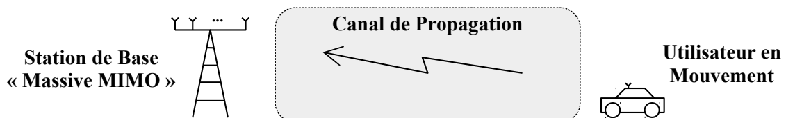
FIGURE 2 : Voie montante d'une communication entre un utilisateur en mouvement équipé d'une seule antenne et une station de base "massive MIMO" équipée d'un grand nombre d'antennes.
