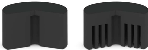
Comparaison entre le piston classique et le piston optimisé à 3 anneaux
