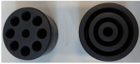
Photographies du nouveau design des pistons : avec des trous (à gauche) et des anneaux (à droite)
