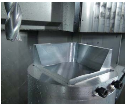
FIGURE 2.13 – Poche 5 axes ouverte et arrondissement local avec grande tolérance
