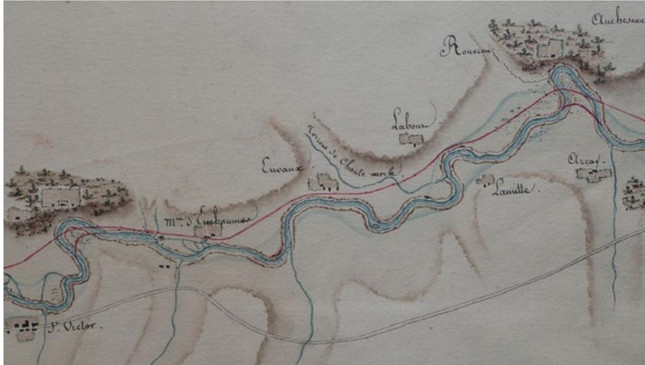
**Figure 2.8** Exemple de recoupements prévus lors du premier projet du canal (AN, F<sup>14</sup> 10091, 1809). Les deux recoupements qui apparaissent ici ont bien été réalisés. Le secteur concerné est situé sur la partie amont du Cher alluvial, entre Saint-Victor et Urçay.
