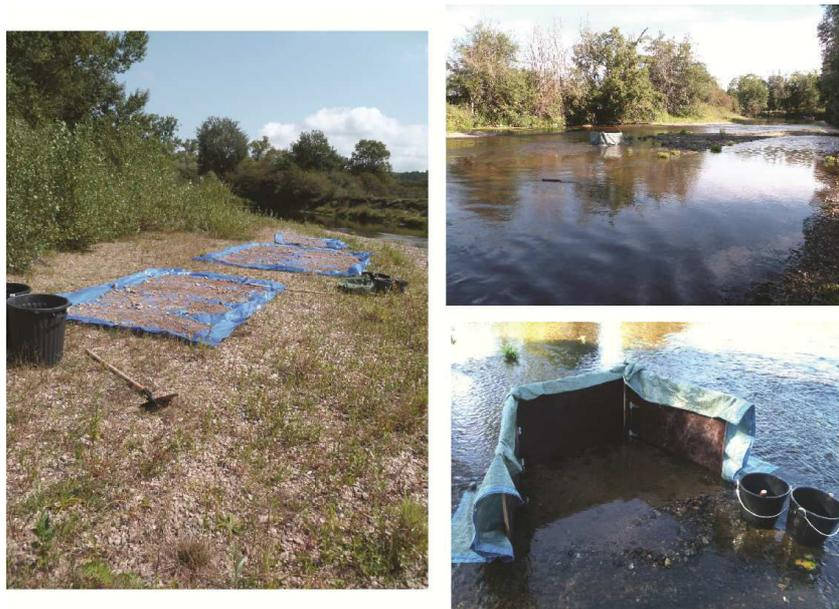
**Figure 7.2** Photographies illustrant la procédure d'échantillonnage volumétrique.
