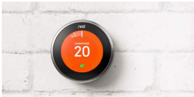
FIGURE 6.5 – Thermostat Nest [85], un SIP pour la sobriété énergétique qui informe les habitants sur la consommation d'énergie passée et présente du chauffage du bâtiment. Thermostat Nest mémorise les habitudes des habitants, baisse automatiquement le chauffage en l'absence des habitants et permet un réglage à distance du thermostat à l'aide d'une application mobile.
