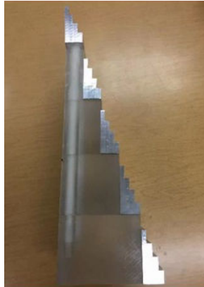
FIGURE II.11 – Photographie d'un escalier de calibration utilisé en rayons X (Source Schmidt et al. [99]). Il est constitué de deux matériaux (aluminium et plastique PMMA).
