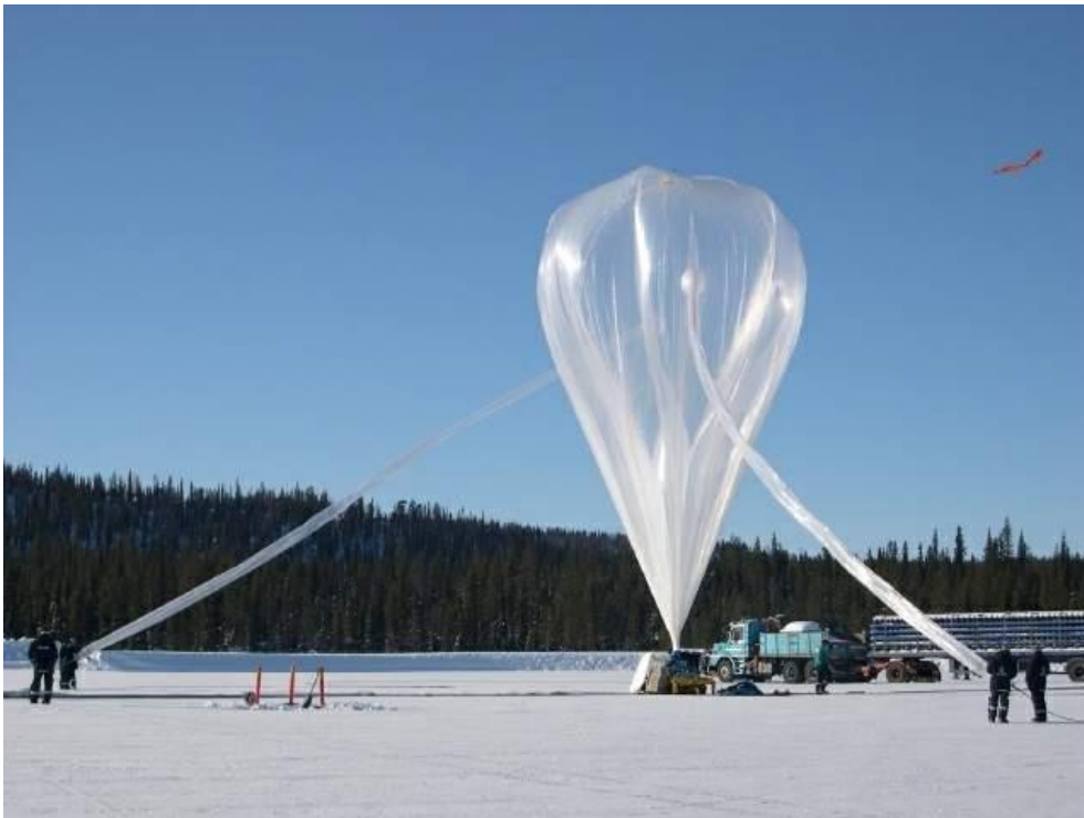
Figure 17 – Gonflage d'un ballon stratosphérique ouvert à Kiruna (©CNES/N. Journo).
