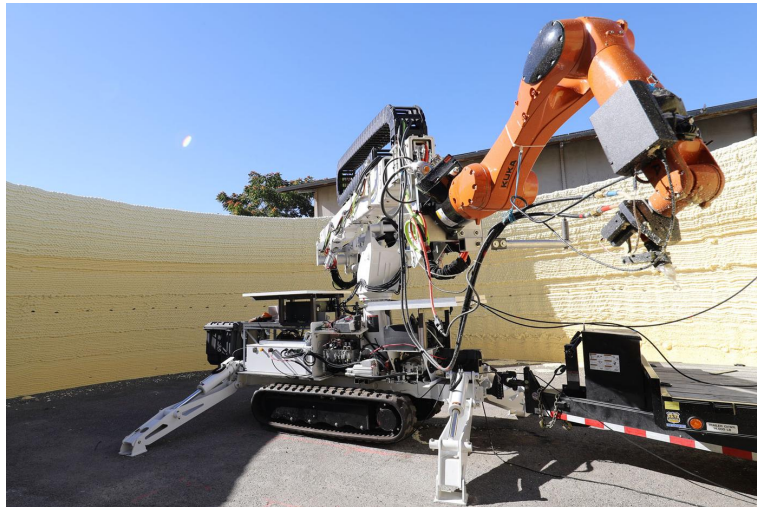
Figure 2.18 – 3D autonomous Robot-printer from MIT
