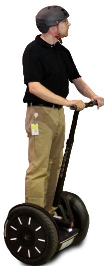
FIGURE 1.3 – Image extraite de [2] Segway : véhicule électrique monoplace, constitué d'une plateforme, muni de deux roues parallèles et d'un manche de maintien et de conduite sur laquelle l'utilisateur se tient debout. Inspirée par les capacités humaines, notre approche permet de reconnaître un objet à partir d'une représentation sémantique.
