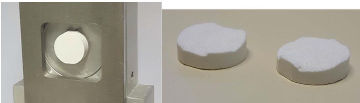
Figure 58: test de cisaillement pour les comprimés pharmaceutiques. Configuration du test (gauche) et exemple de facies de rupture après le test (droite)
