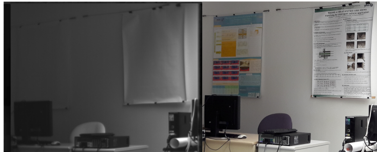
FIGURE 2.14 – Exemple de sérigraphie observée dans le spectre visible et dans le spectre infrarouge : alors que les formes imprimées sont perceptibles dans le visible, le poster semble vierge dans le spectre infrarouge.
