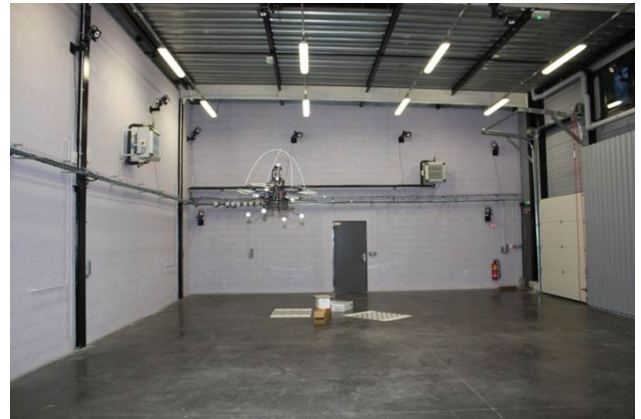
(b) Le drone Pelican dans la salle VICON. L'espace disponible pour la navigation est de 15 \times 10 \times 5 \text{ m}^3 équipé avec 20 caméras Vicon T40S.
