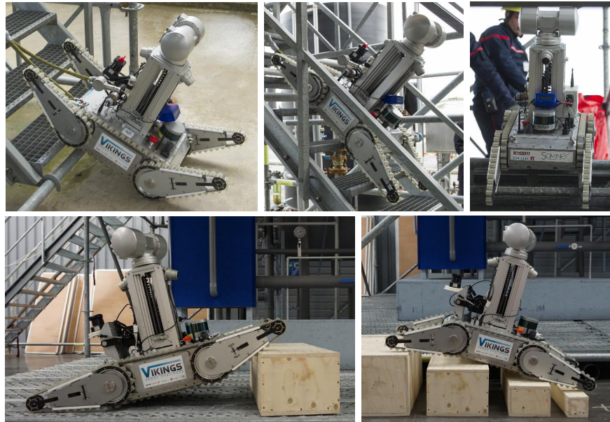
FIGURE 4.17 – Exemples de trajectoires 6 ddl exécutées par le robot Viking : négociation des escaliers sur les installations du site de la compétition (en haut), franchissement d’obstacles (en bas).
