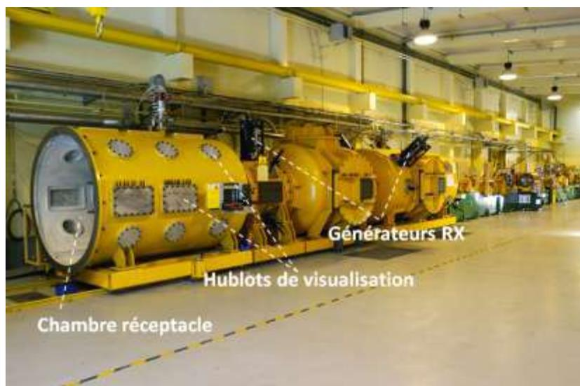
Figure 64: Photo d'illustration du lanceur ATHENA, chambre réceptacle ouverte
