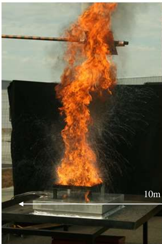
BoilOver en feu de nappe (40cm x 40cm) : distance de sécurité 10m (image LGEI-ISR)
