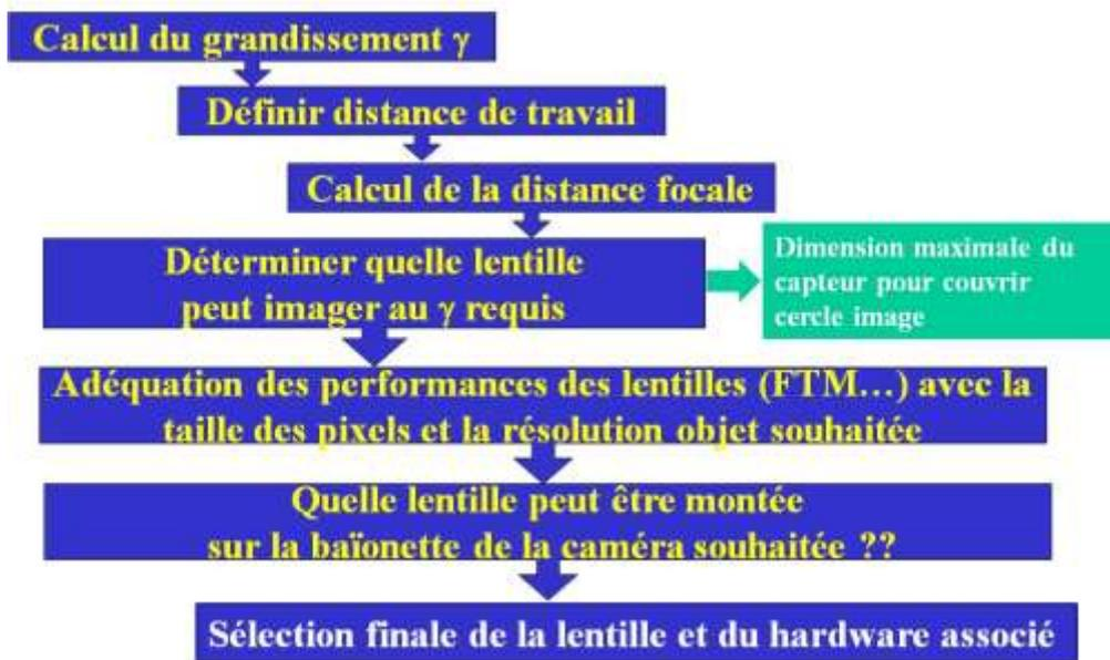
Figure 39: Sélection d'une optique adaptée
