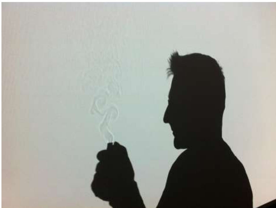
Figure 81: Visualisation de la chaleur d'un briquet en salle de cours par ombroscopie
