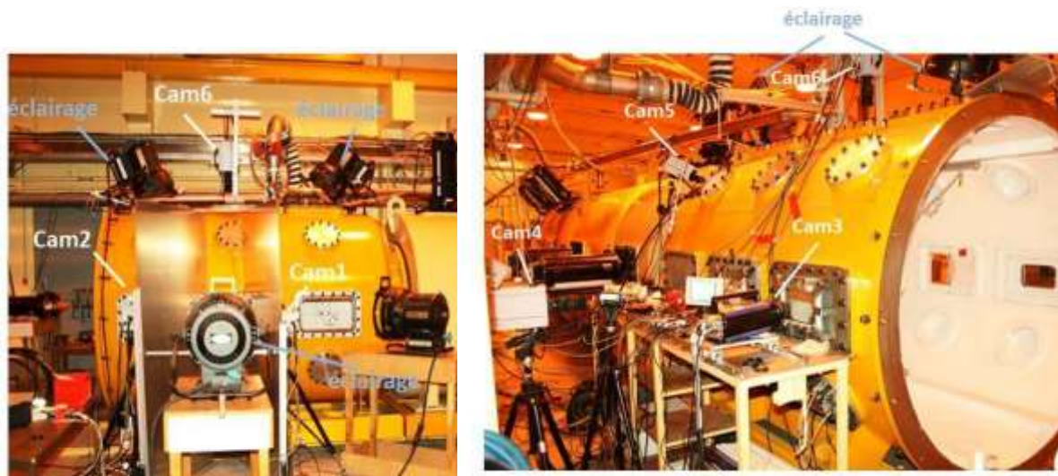
Figure 69: Positionnement sur site d'essai des moyens d'imagerie rapide
