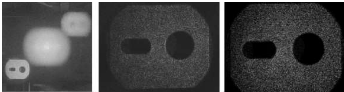
a) DFH par DFT (complète) b) DH : convolution + grandissement c) DIPH
