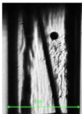
Figure 83: Mise en évidence d'une goutte de Methyl Ethyl Cetone ( n_{\text{MEK}}=1,377 ) par strioscopie en Z
