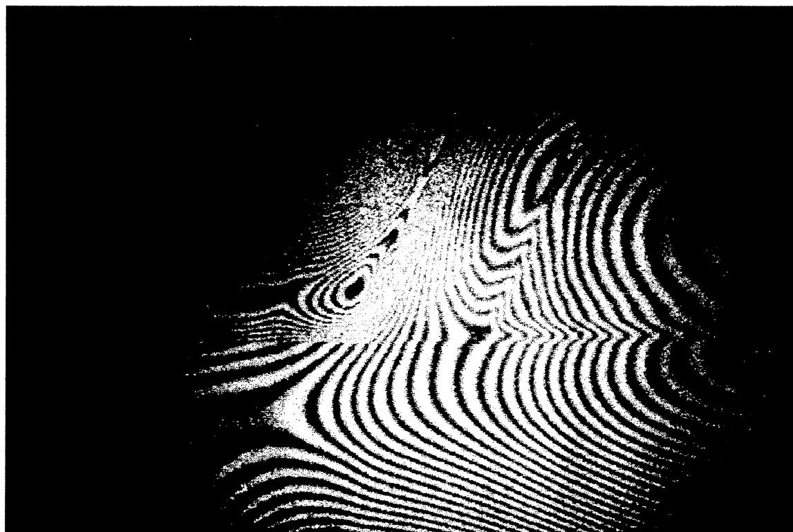
Fig.6.27: P2 Mise en évidence du coin d'épaisseur (zone étudiée 20x30 cm)
