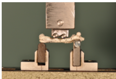
Figure 69 : Test de flexion 4 points sur fémur de rat
