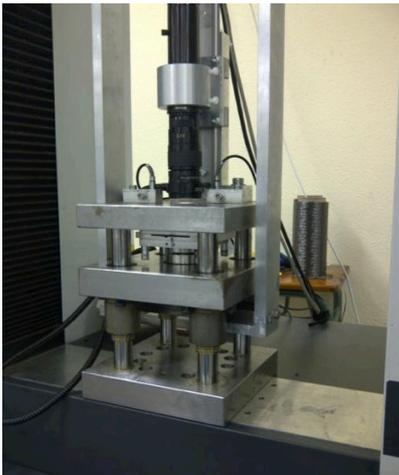
Figure 48 : Vue d'ensemble du dispositif de compression transverse pour fibres et fils [5]
