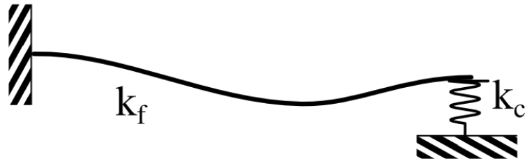
Figure D1. – Poutre encastré-ressort
