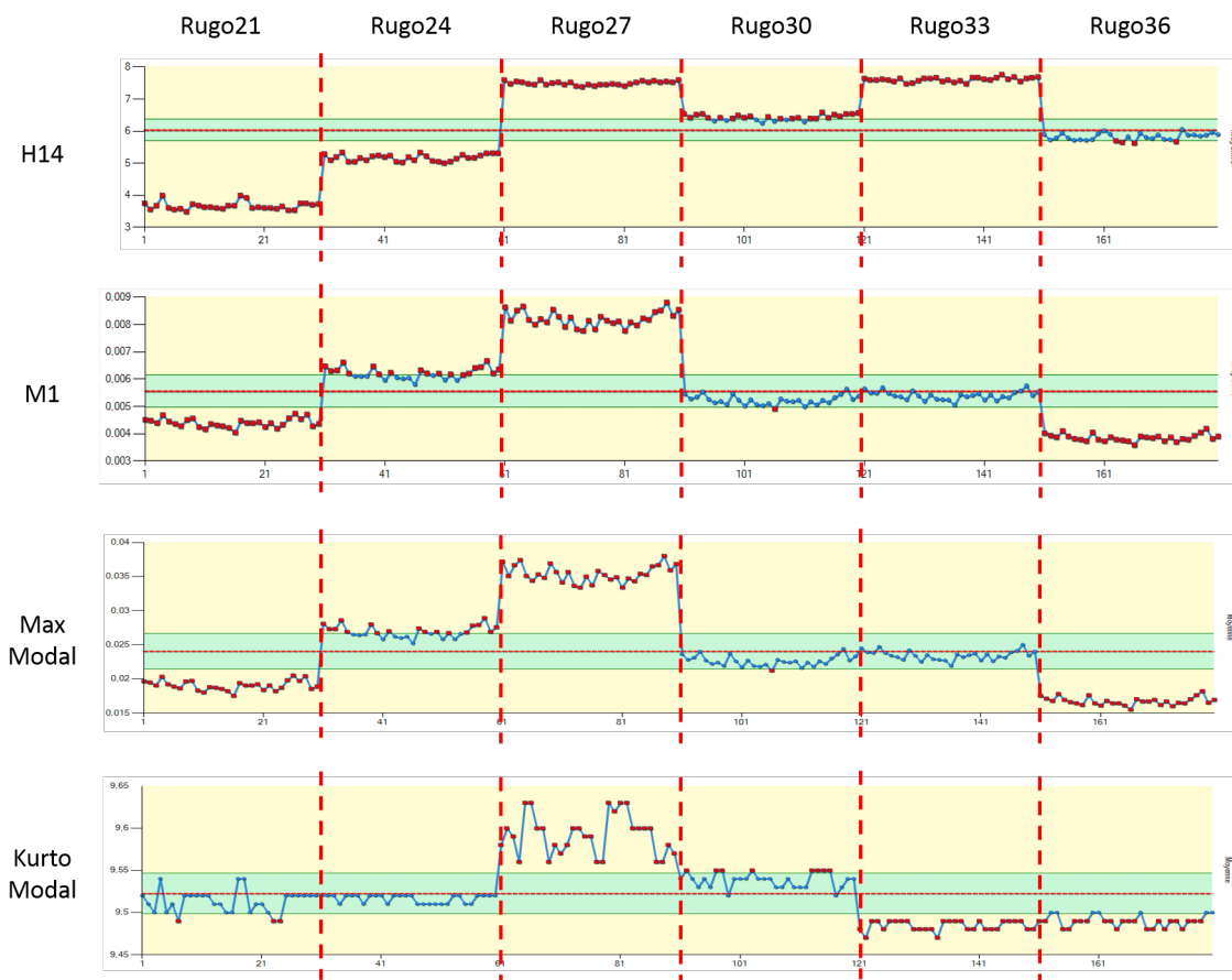
Figure 2.21 – Evolution de certains des paramètres utilisés pour la classification des rugosités. De haut en bas : 14ème paramètre d'Haralick, 1er coefficient modal, maximum et kurtosis de la distribution des coefficients modaux.
