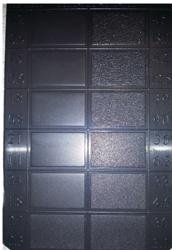
Figure 2.19 – Plaquette charmille présentant des étalons de différentes rugosités
