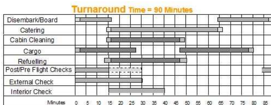
FIG. 3.1 – Décomposition des actions d'exploitation de l'avion lors du TAT
