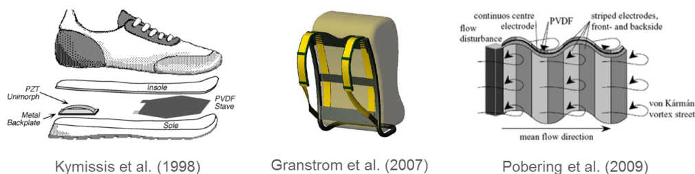
Figure 1.6 – Exemples de générateurs à déformation directe. De gauche à droite : [21], [22], [23].
