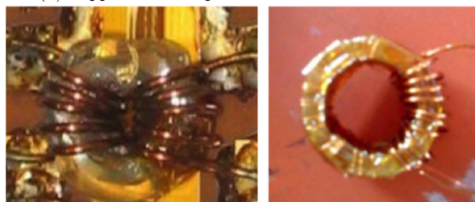
(c) Enrobage des matériaux avec un polymère (gauche) et avec un film adhésif polyimide (droite)
