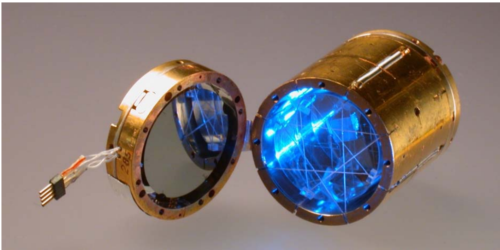
Bolomètre IAS de 91g en BGO avec son détecteur optique
