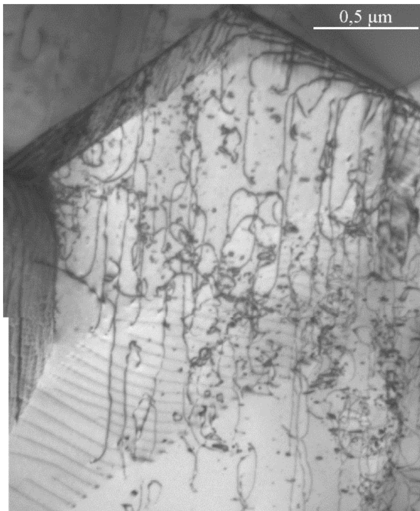
Micrographie par MET d'un échantillon TiAl déformé en compression de 20% à 1100°C.
