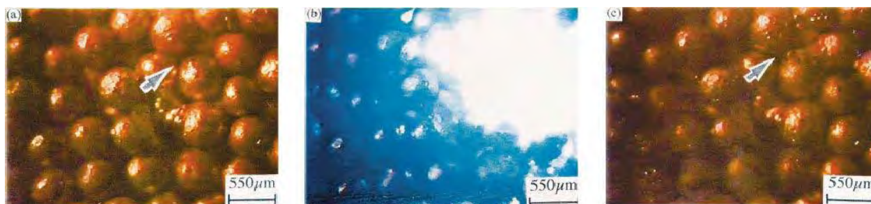
Figure I-8 : Séquence d'images séparées de 0,02s d'un arc électrique (b) entre particules de Cu de 550 \mu\text{m} de diamètre soumises à un pulse de courant de 6700 A/cm 2 pendant 100 ms [Yanagisawa 2003].
