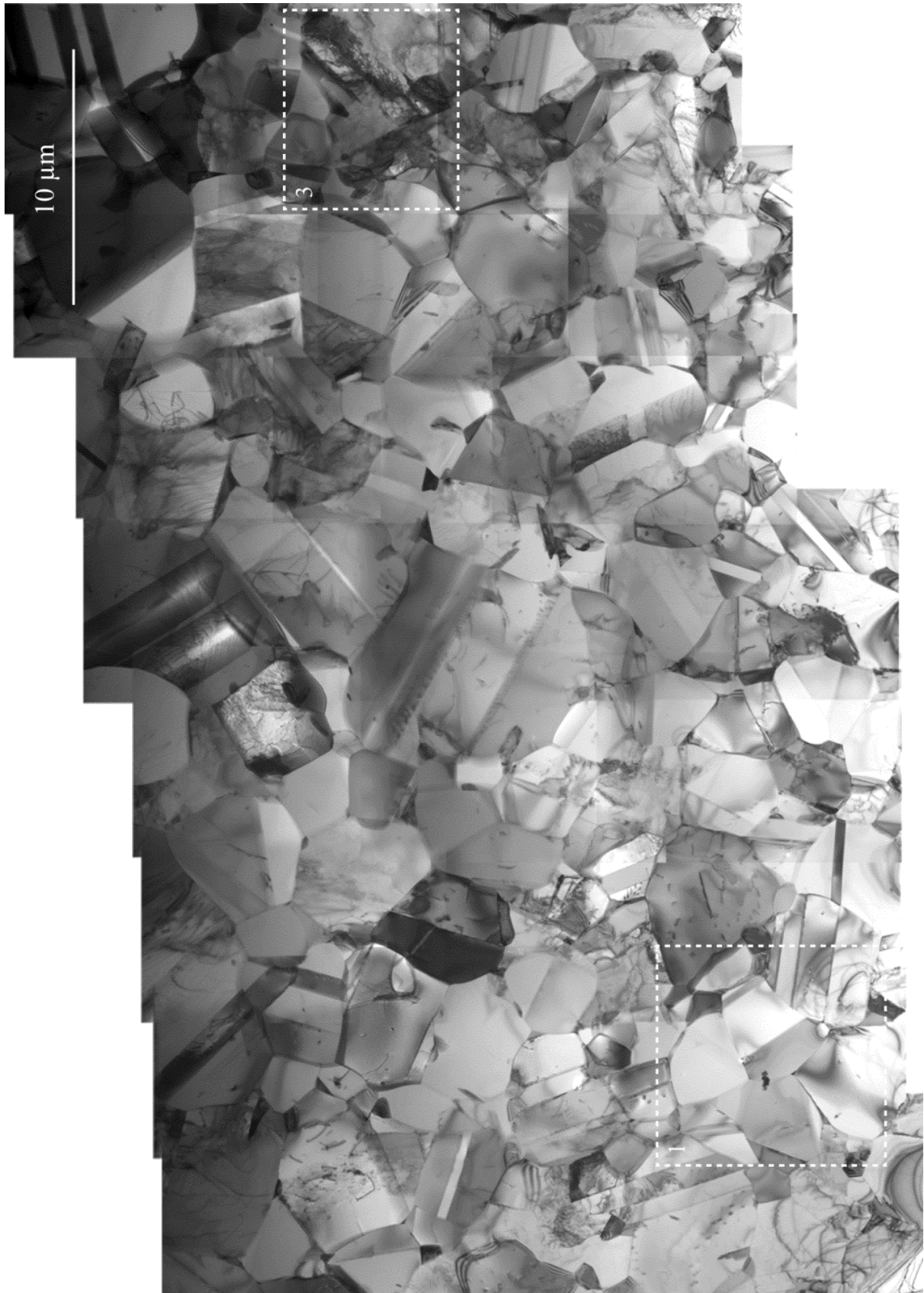
Figure V-13 : Image MET d'une zone étendue de l'état déformé de 20% à 1100°C. Les zones repérées par des pointillés blancs sont présentées à plus fort grandissement.
