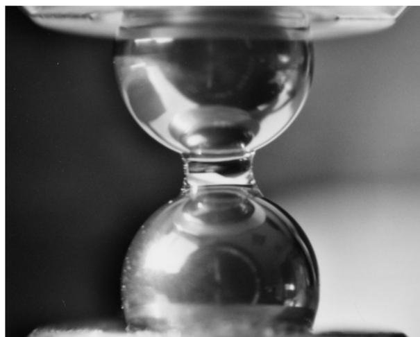
FIGURE 1.3 – Pont liquide entre deux billes d'acier inoxydable [?].
